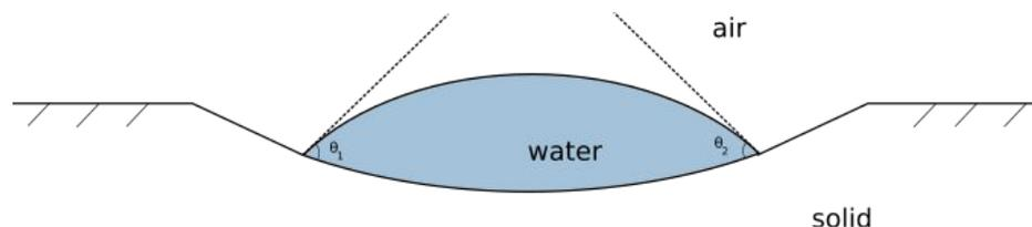
**Abb.** Benetzung einer Oberfläche anhand der dynamischen Kontaktwinkel
